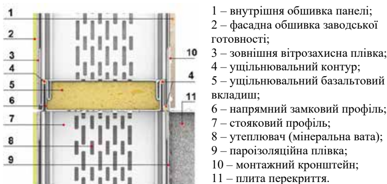
Рис. 5. Замкове з'єднання навісних стінових панелей
